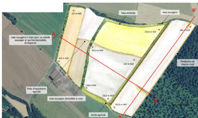
Profils topographiques du réaménagement final intégrant le remblaiement au TN des phases 3 et 4
